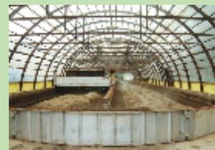
さらに横型ロータリー式発酵槽で毎日攪拌、約20日間発酵処理する。
